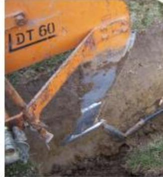
Bild 6: Schlauchpflug mit automatischen Schlaucheinzug
